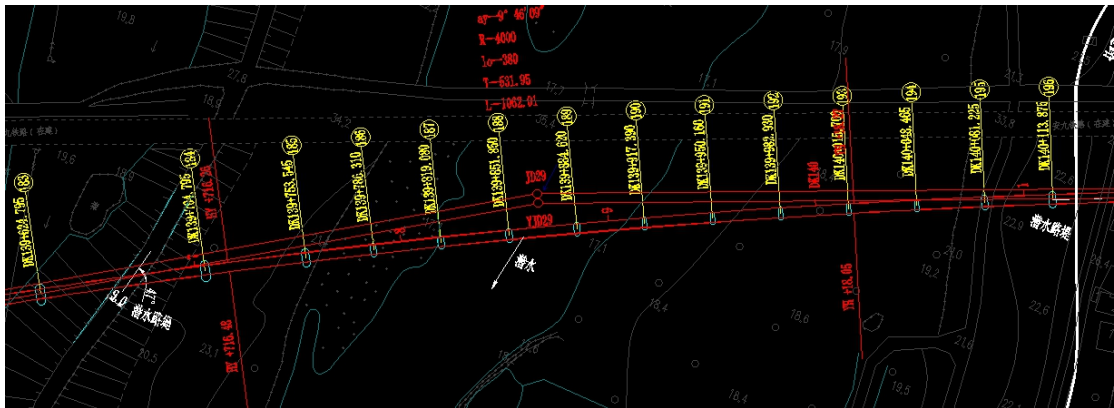
图 2.1-15 潜山特大桥（跨潜水）桥墩布置图
