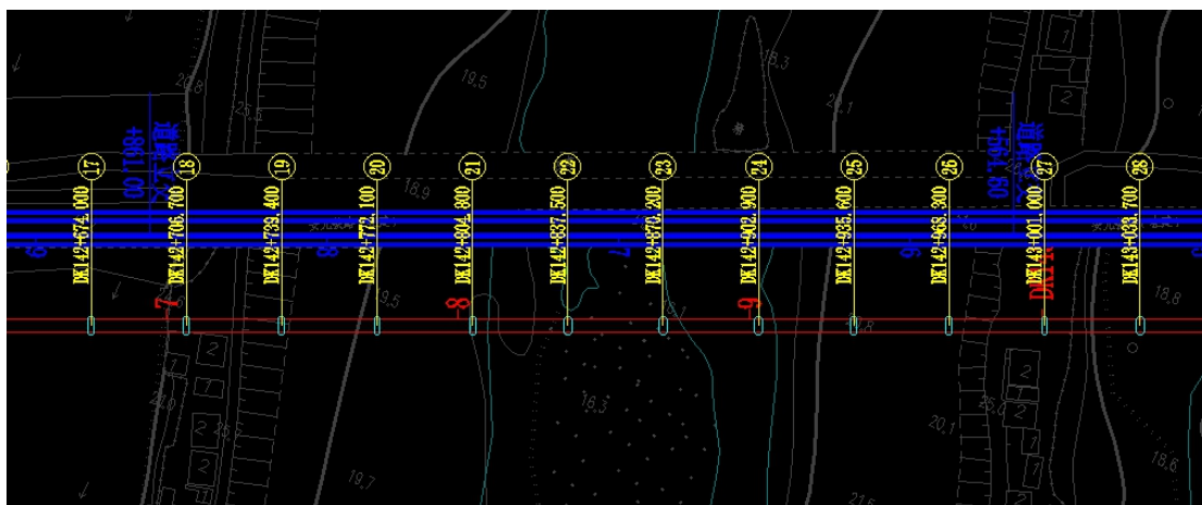
图 2.1-17 皖水特大桥桥墩布置图
