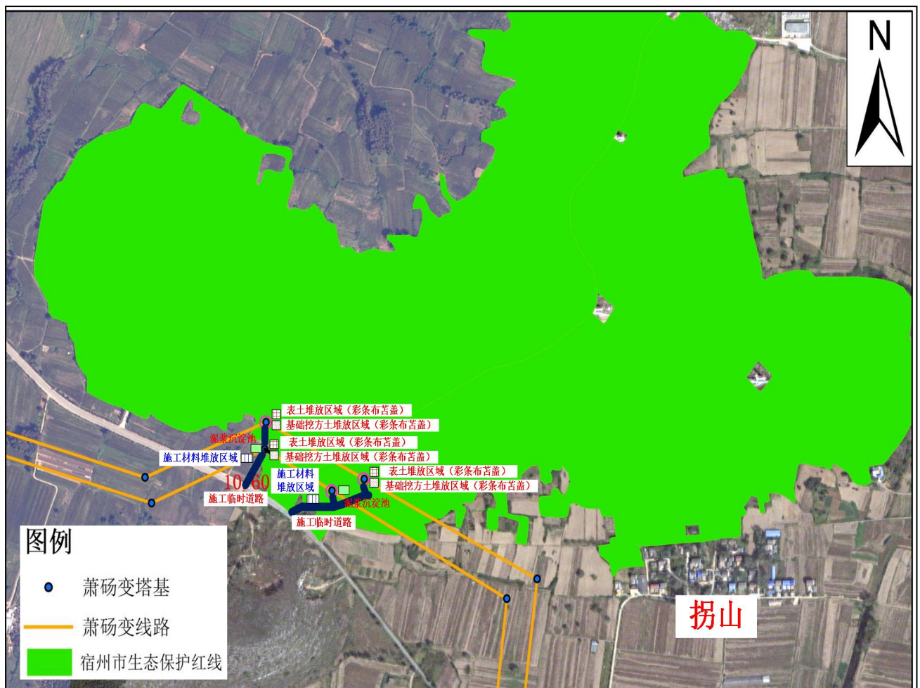
图 3.15 线路穿（跨）越生态保护红线段施工现场布置示意图（埇桥区曹村镇拐山西侧）
